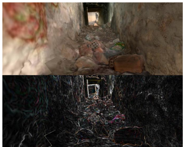
Figura 11: Filtro de bordes aplicado sobre la imagen de una vista concreta del interior del túnel del búnker.
